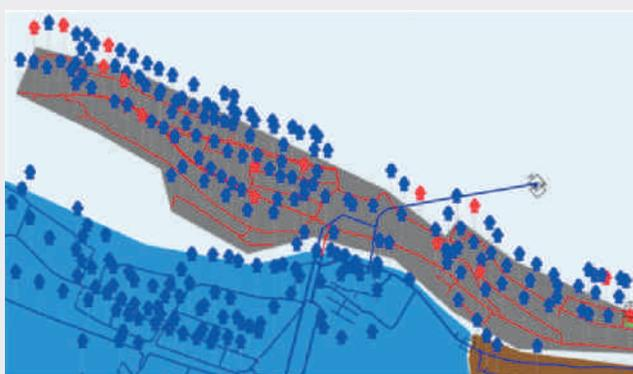
a) Spülzone grau zum Simulationsstart (Startkonzentration: 1000 mg/l)
