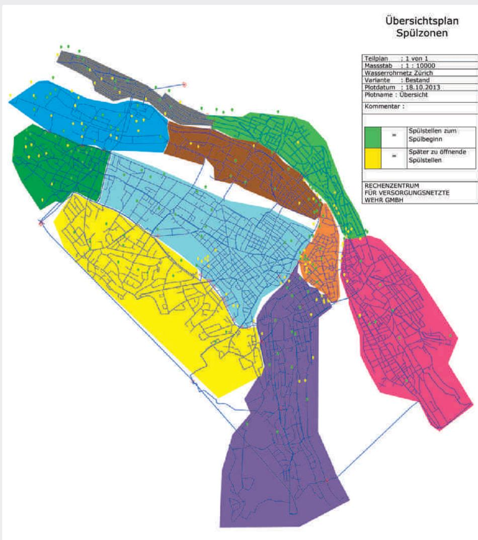
Fig. 1 Spülzonen der Limmatzone (mit Einfärbung)
